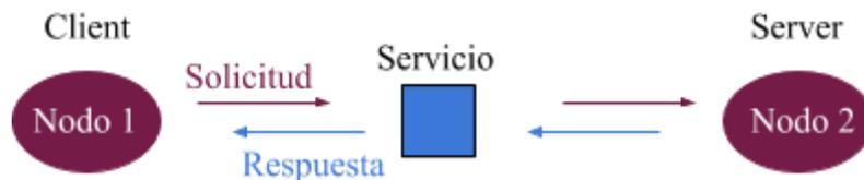
Fig. 9: Petición de un servicio por un nodo y respuesta del nodo servidor.
