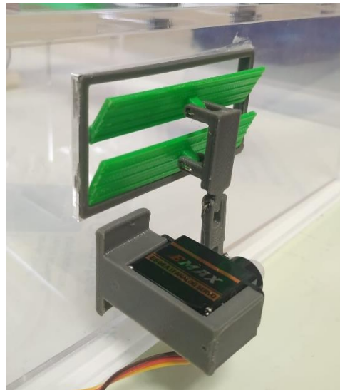
Ilustración 33: Conjunto de elementos impresos en 3D que representan el sistema de apertura las ventanas
