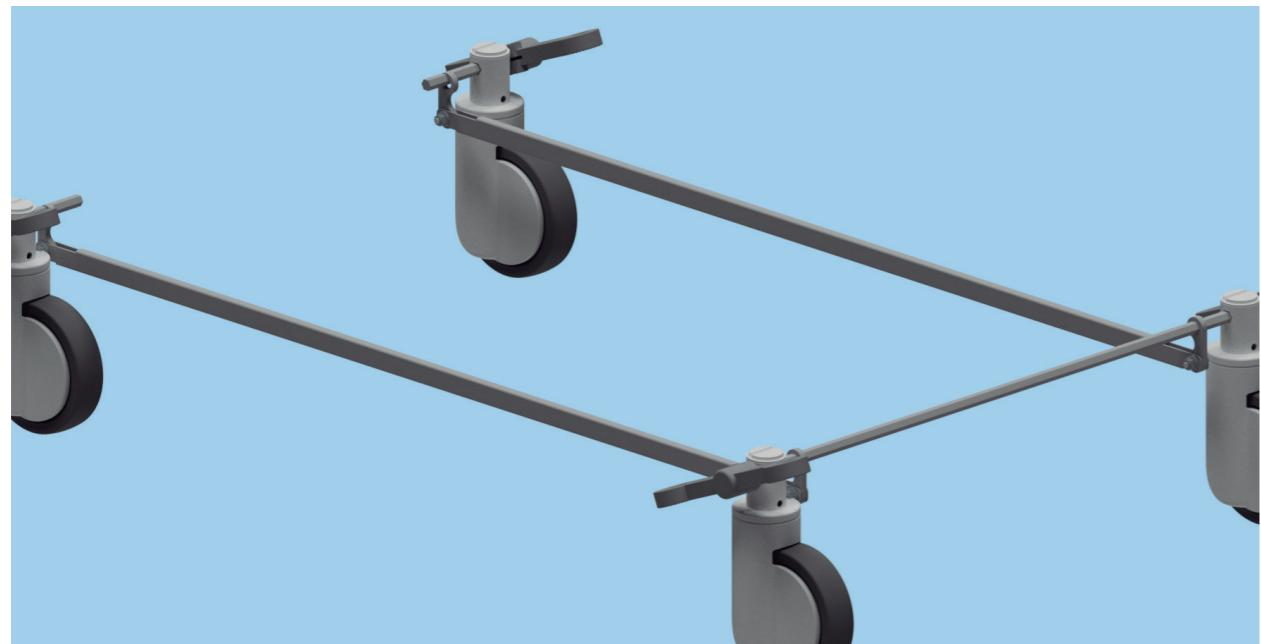
Con todo esto se consigue que al pisar cualquiera de los cuatro pedales, el eje exagonal al que se encuentra ligado rota y activa las bielas longitudinales haciendo rotar a los otros ejes exagonales y bloqueando o liberando las ruedas.
