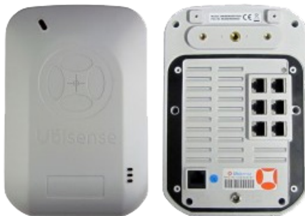
Figura 2.12. - Sistema de localización a tiempo real ubisense.
