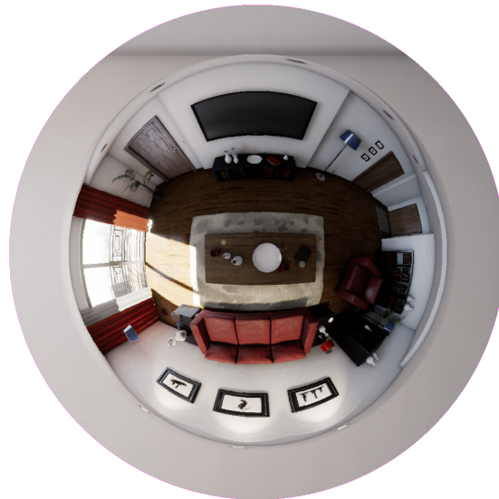
Figura 3.20: Ejemplo de imagen catadióptrica con espejo esférico de radio 50cm
