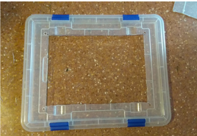
Hueco recortado en la tapa
