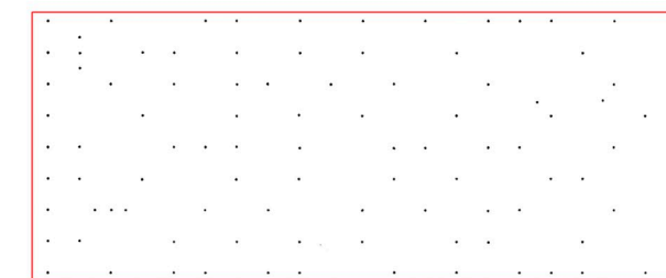
Fig.70 / Diagrama estructural Casa N , bosque de pilares estructurales, la disipación estructural es total, tanto por el número, colocación como por el diámetro. La envolvente se lleva al límite, que al ser de vidrio crea una espacialidad infinita. Marta Lorente.
