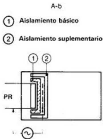
Figura A. 4- Configuración de ensayo de rigidez dieléctrica A-b. Norma UNE-EN 20613.
