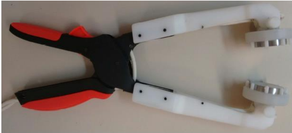
Figura 5- Electrodo de placas planas usado para experimentación en hígado de cerdo.
