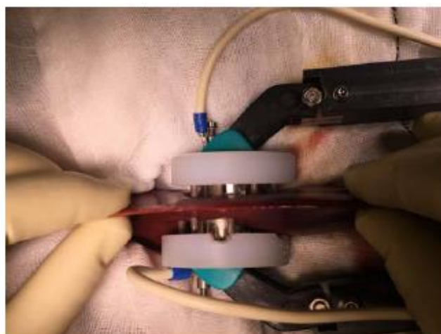
Figura 8- Aplicación del electrodo sobre hígado de cerdo.
