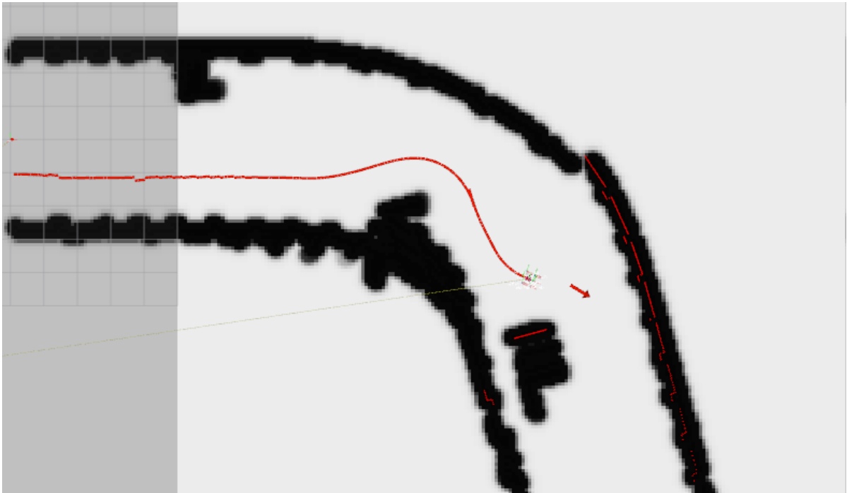
Fig. 28 Trayectoria seguida por el robot, en el mapa II, usando "Wall Sliding Balloon"
