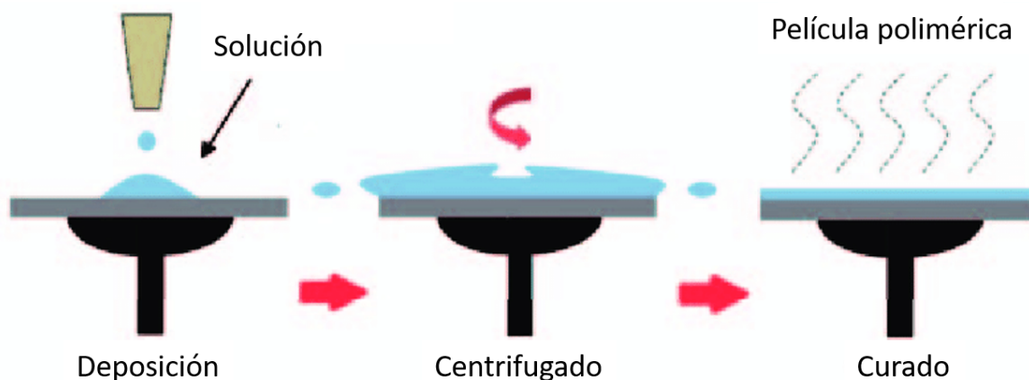
Figura 3.5: Proceso de la deposición de la película polimérica sobre el sustrato[17].
