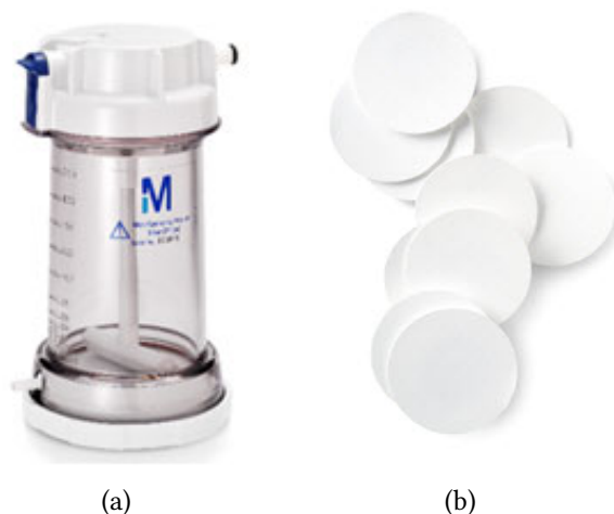
Figura 3.3: (a) Celda ultrafiltración Amicon®Stirred, (b) Filtros de corte (membranas).
