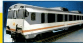
Automotor 596 construido sobre carrocería de resina.
