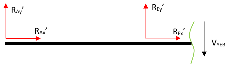
Figura 7.6: Reacciones cortante barra 1 (corte 2)
