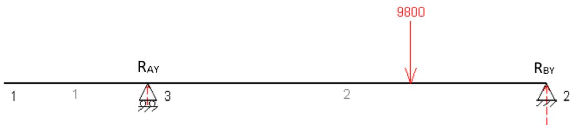
Fig. A 1.3.1. DSL Tablero carga descentrada 1.7m de altura.
