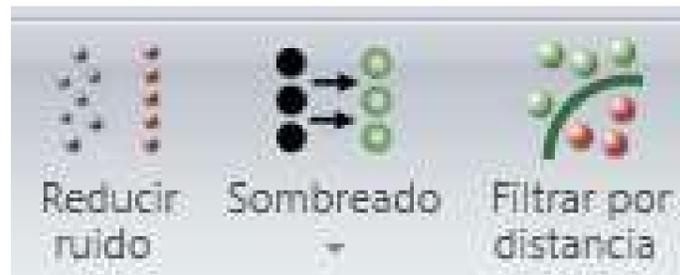
**Eliminación de puntos ajenos al modelo a escanear.** Siempre que se escanea un objeto mediante este tipo de técnicas láser para generación de nubes de puntos, se cometen errores de recogida de datos en forma de elementos no pertenecientes al objeto que interesa extraer un modelo digital, este es el caso de elementos de apoyo del objetivo, como por ejemplo, la mesa donde descansaba el brazo a medir. El paso principal es eliminar de la nube todos los puntos pertenecientes a este tipo.
