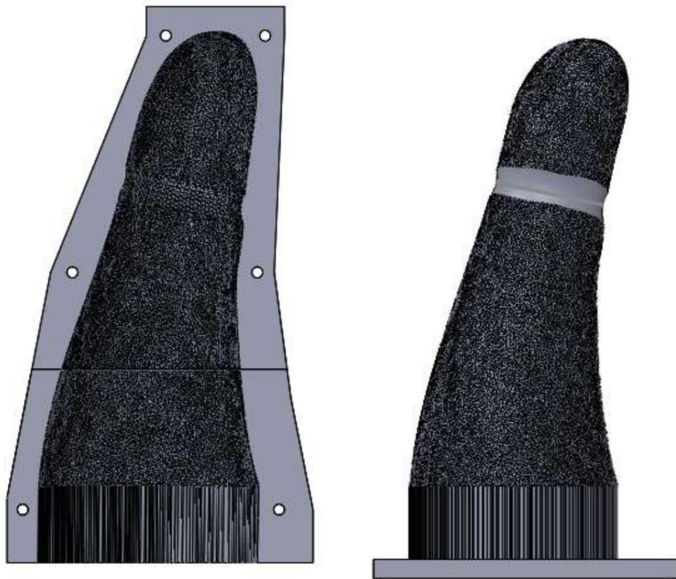
do una pequeña hendidura en el molde macho y un pequeño saliente en el molde hembra, con el fin de mantener el espesor del guante y tener una zona que apriete más el brazo que otras.
