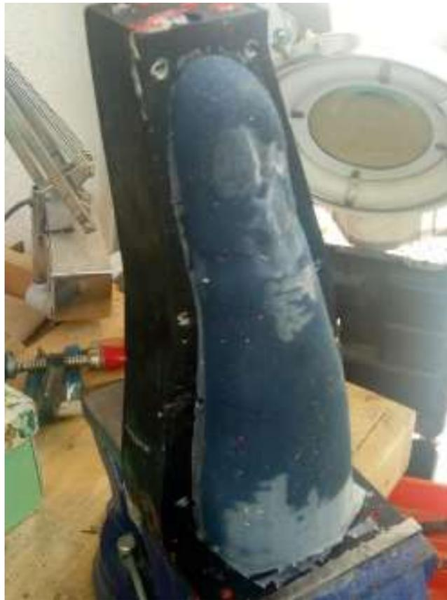
Foto del proceso de extracción del guante, se puede ver la forma de la silicona recubriendo el molde macho y la mitad del molde hembra retirado, con el bebedero en la parte superior del molde negro hembra.
