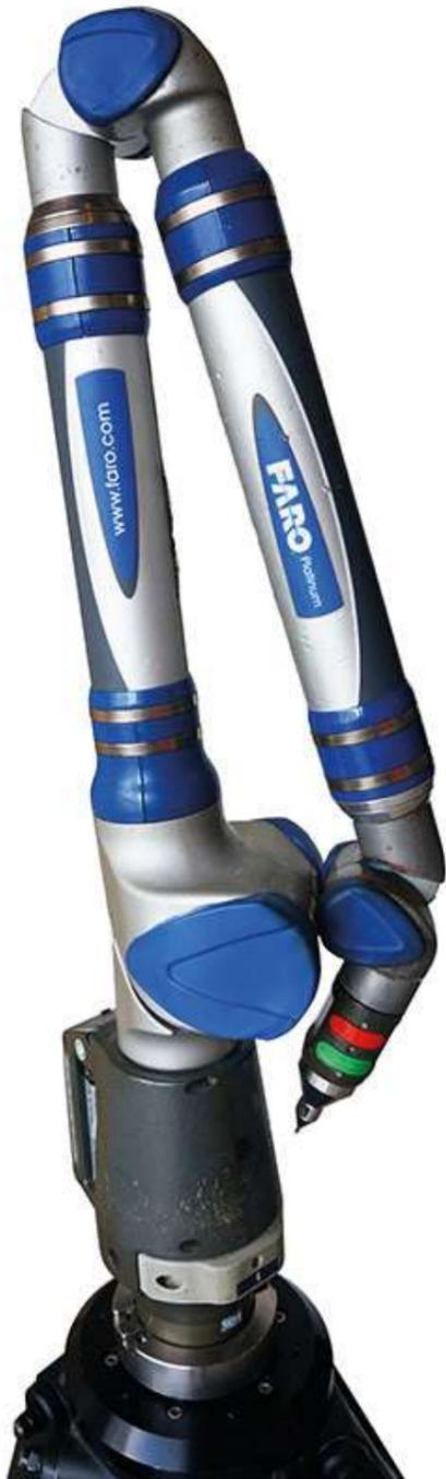
Este es el brazo de **medición láser FARO**, usado en aplicaciones de ingeniería inversa para reconstruir productos de forma fiel a la realidad en un modelo digital. El sistema con el que lo hace es mediante un **haz lineal láser**, cuya función es arrojar una gran cantidad de puntos que rebotan contra el producto a medir, lo que luego se recogerá en forma de **nube de puntos** en el programa de ordenador.
