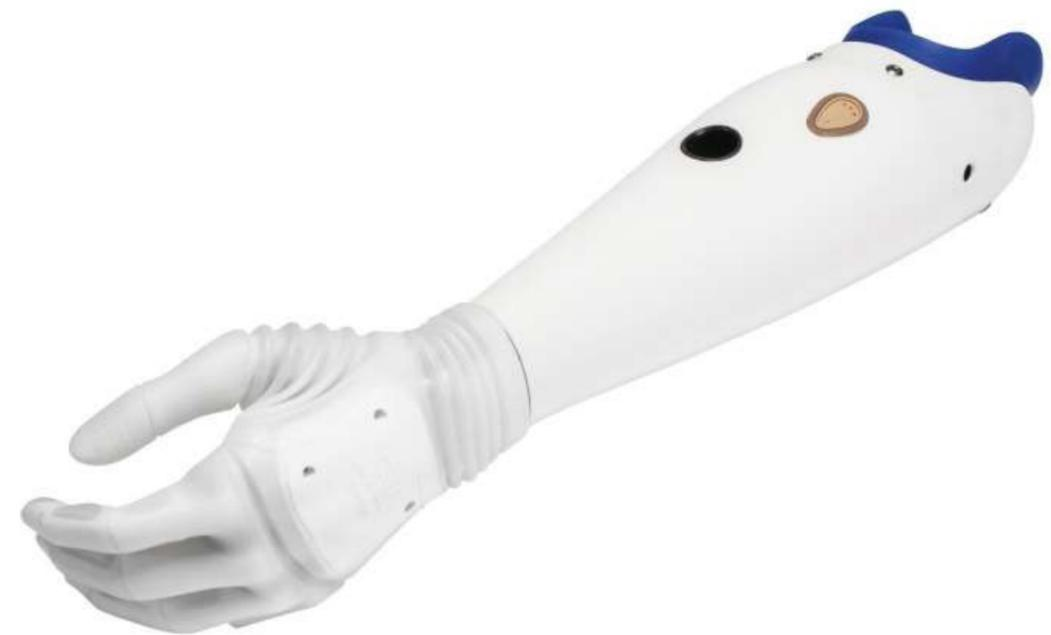
La que se muestra en la foto es un mano Michelangelo con la parte del antebrazo integrada en la mano, se pueden apreciar los electrodos que permiten el movimiento de los motores.
