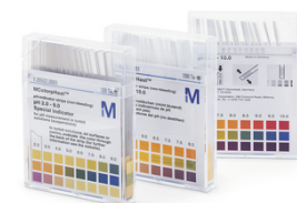
Figura 6. Tiras indicadoras de pH con su escala de referencia de colores. 18
