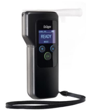
Figura 17. Etilómetro de muestreo que permite llevar a cabo una prueba de alcoholemia de manera rápida y precisa. 68
