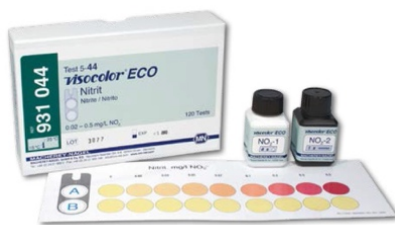
Figura 11. Kit de ensayo para el análisis de aguas VISOCOLOR® nitrito. Consiste en un ensayo colorimétrico en el que la sulfanilamida es diazotizada por nitrito en medio ácido dando lugar a una sal de diazonio que se acopla con una amina formando un colorante rojo intenso que se evalúa por comparación visual del color obtenido con los colores de referencia que contiene el kit. 31
