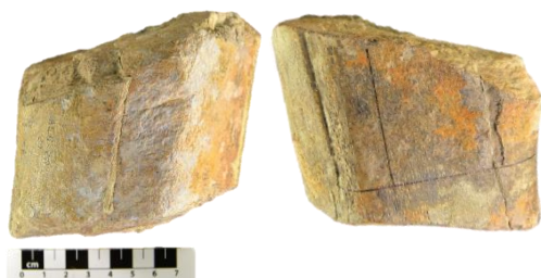
Figura 5. a) Fotografías de visu en dos vistas de la muestra BLA 2A-20, con los cortes realizados indicados en una de ellas. b) Láminas delgadas obtenidas a partir de esta muestra. El lado corto de las láminas es de 52 mm.
