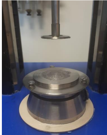
Figura 7: Plato (abajo) y cono (arriba) de reómetro HAAKE RheoStress 1 empleado en los ensayos de reología.
