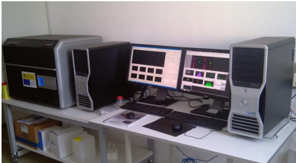
Fig 5: Fotografía del citómetro de imagen AMNIS ISX100 conectado a las pantallas para permitir visualización. SAI. Servicio de Apoyo a la Investigación. Universidad de Zaragoza.
