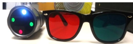
Fig. 4 Linterna de Worth y gafas anaglifas rojo/verde.
