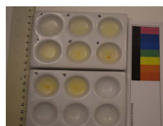
Figura 12: Captura imagen del procedimiento de determinación de putrescina en disolución
