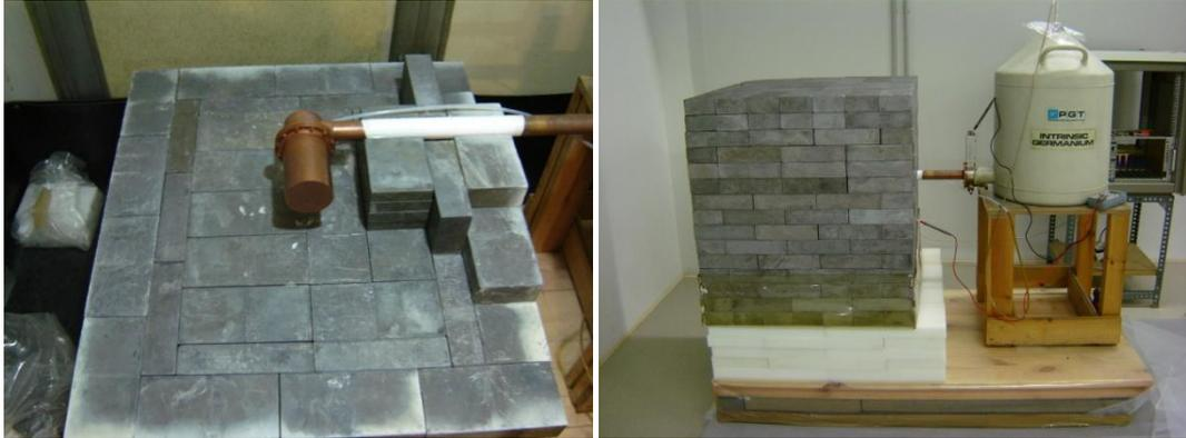
**Figura 2:** Foto del detector de HPGe y su blindaje.
