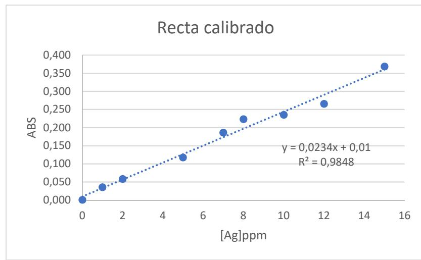
ANEXO 3: RECTA DE CALIBRADO UTILIZADO PARA OBTENER LOS VALORES DE CONCENTRACION EN LAS MUESTRAS.
