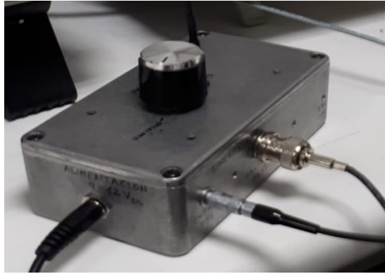
Fig.16 Regulador fibra óptica
