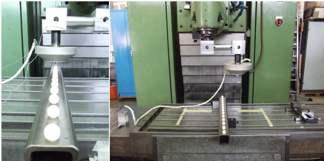
Figura 5.2.2-3 Mediciones de la barra de bolas en las posiciones Y_1 , Y_2
