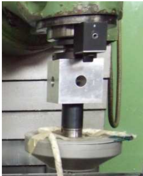
Figura 5.2.3-1 Utillaje utilizado para las mediciones en X y sus diagonales
