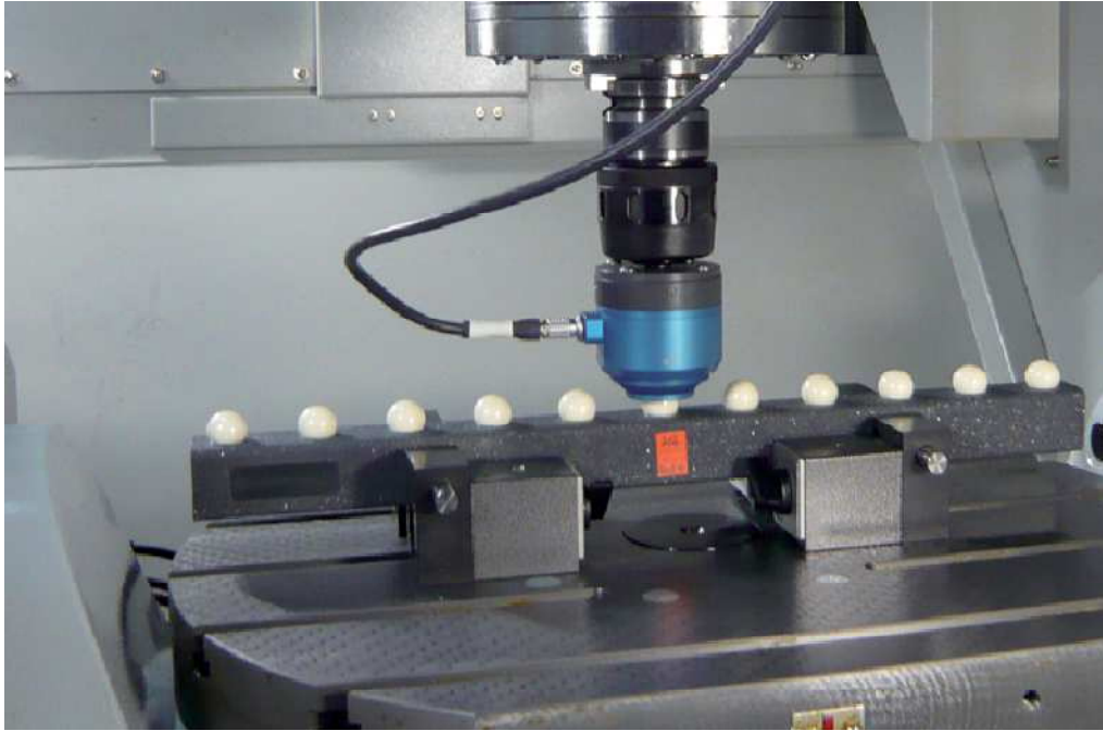
Figura 2.2.4-2 Palpador MT-Check midiendo una barra de bolas calibrada
