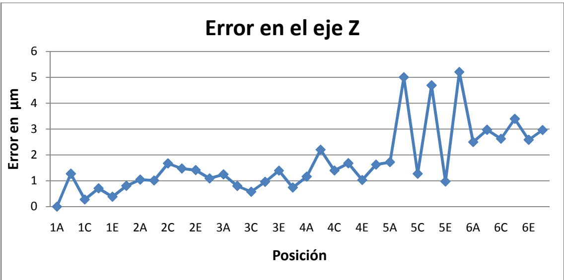
Figura 3.3-3 Error en el eje Z en micras
