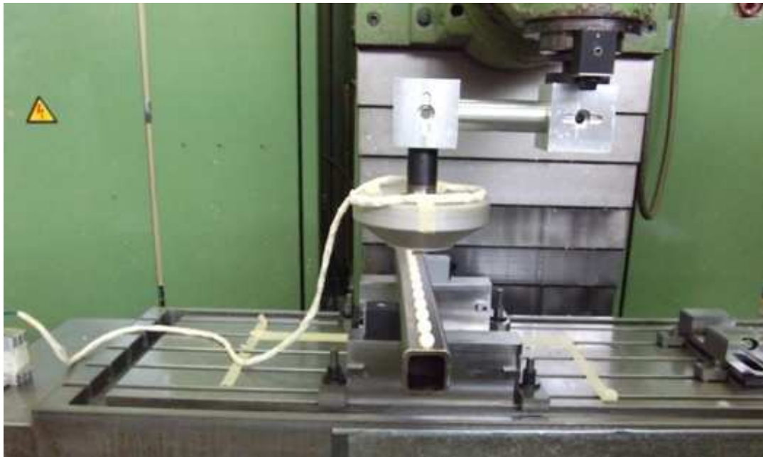
Figura 5.2.2-4 Mediciones de la barra de bolas en la posición Y_4 con los bloques patrón
