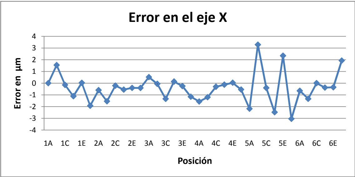
Figura 3.3-1 Error en el eje X en micras
