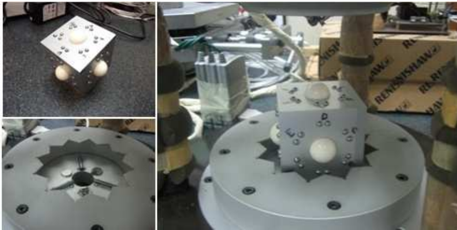
Figura 3.2.1-1 Cubo de calibración y plataforma
