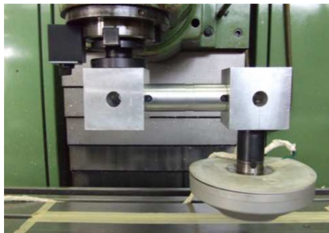
Figura 5.2.2-1 Utillaje utilizado para las mediciones en Y
