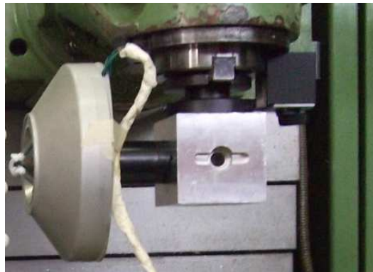
Figura 5.2.1-2 Utillaje utilizado para las mediciones en Z y sus diagonales
