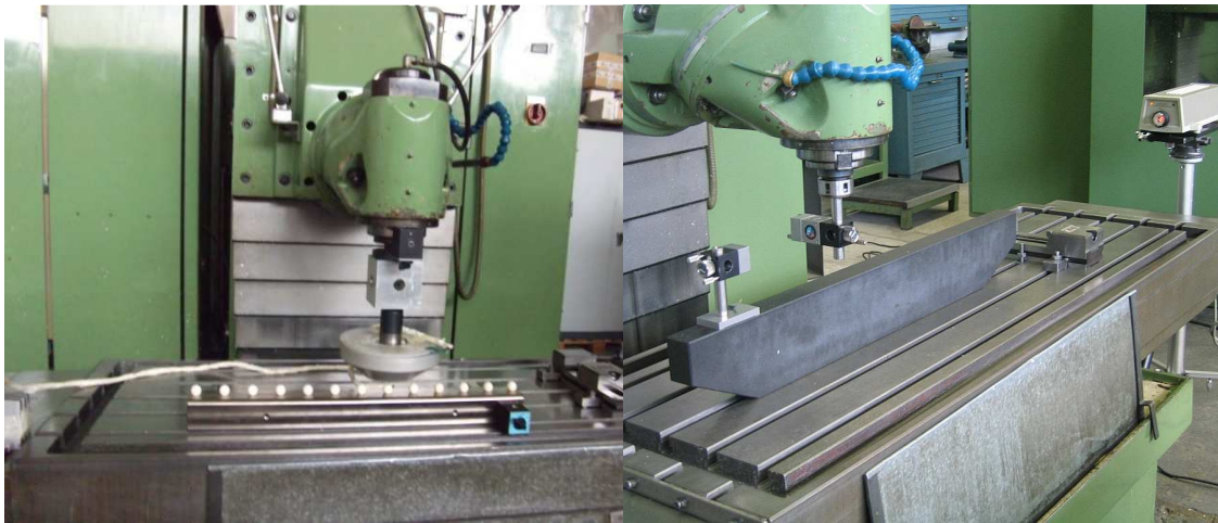
Figura 5.3 Medición según el método del palpador autocentrante y del interferómetro laser.
