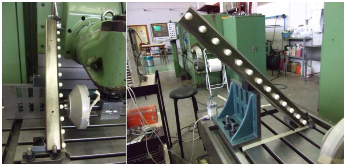
Figura 5.2.1-4 Mediciones de la barra de bolas en las posiciones YZ_1 e YZ_2
