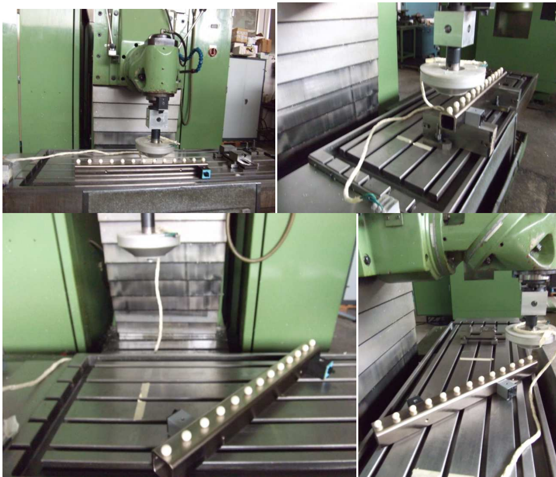
Figura 5.2.2-3 Mediciones de la barra de bolas en las posiciones X_1 , X_3 , XY_1 y XY_3
