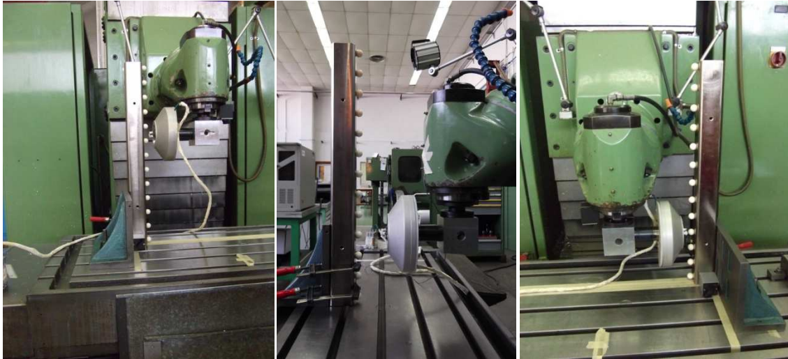
Figura 5.2.1-3 Mediciones de la barra de bolas en las posiciones Z_1 , Z_2 y Z_3
