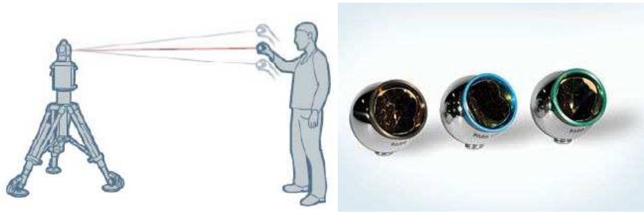
Figura 2.2.3-2 A la derecha funcionamiento del seguidor, a la izquierda reflectores del laser tracker
