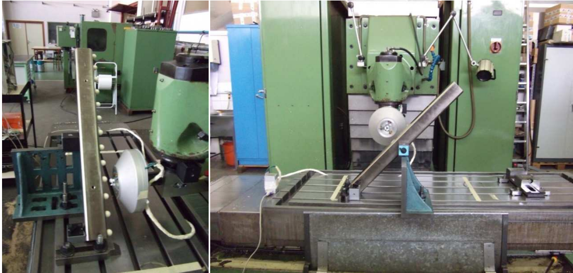
Figura 5.2.1-5 Mediciones de la barra de bolas en las posiciones XZ_1 e YZ_2
