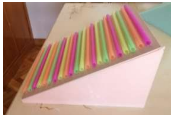
FIGURA 5. PLANOS INCLINADOS: se muestra. A) Los planos inclinados de goma espuma sin modificar su superficie. B) A modo de ejemplo se presenta un plano inclinado con su superficie modificada mediante pajitas.
