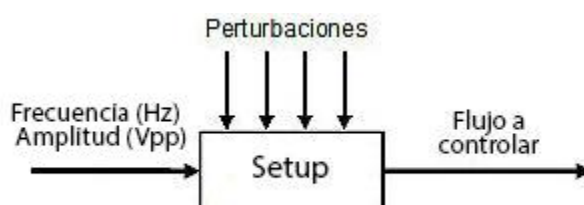
FIGURA 22: DIAGRAMA DE BLOQUES DEL CONTROL EN LAZO ABIERTO
