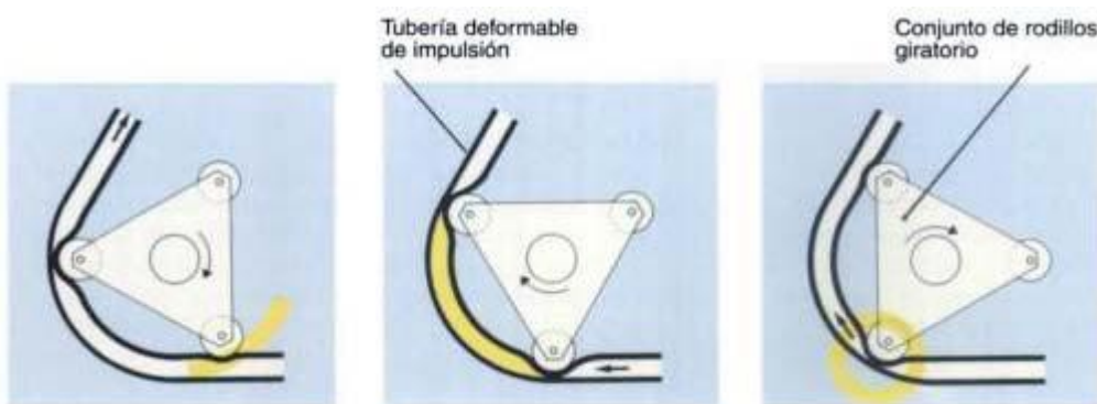
FIGURA 29: PRINCIPIO DE FUNCIONAMIENTO DE UNA BOMBA PERISTÁLTICA
