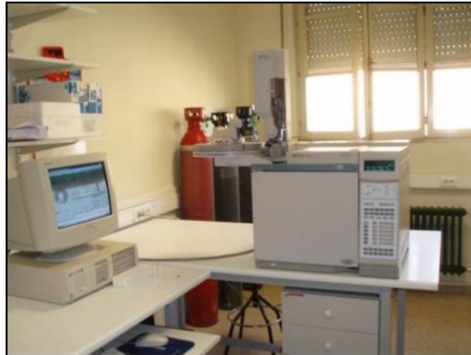
Cromatografía de gases para la determinación del perfil de ácidos grasos.
