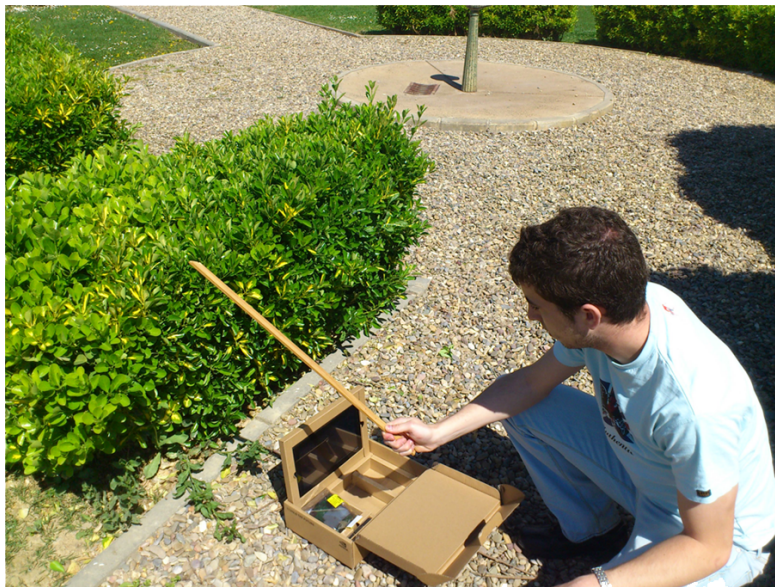
Figura 3.12: Configuración del entorno móvil. El tablet NVIDIA realiza la grabación de la escena sobre la cual se proyecta y se desplaza de lado a lado la sombra de la varilla de madera.
