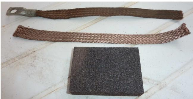
Usaremos un cable plano en lugar del actual cable multifilar rizado.
