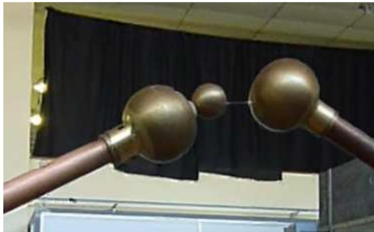
La máquina tiene metálicas sin aislar con barniz ANTI-FLASH G-142, como las barras que permiten variar la proximidad entre las esferas “explosores”, de modo que sustituimos las barras y las esferas por un cable conductor sujetado a una pértiga de alta tensión. Eliminando en un golpe las esquinas y todo ese material conductor al aire.
