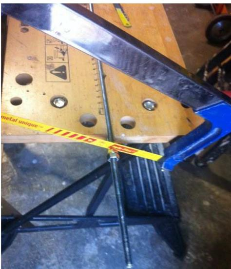
Posterior mente calculamos la longitud de la barra roscada de M8 necesaria para atravesar las diferentes piezas y roscarse en el interior de la barra de madera y la cortamos con una sierra para metal.
