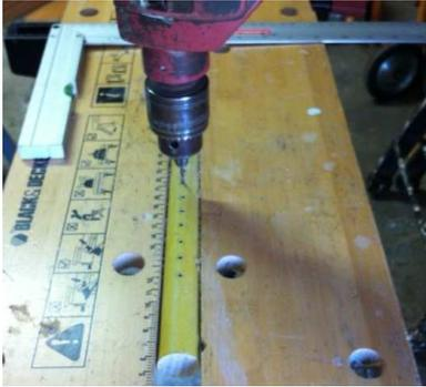
Para colocar la serie de condensadores cortamos dos barras de madera y le realizamos una serie perforaciones separadas 1,5 mm entre cada una de ellas, esta separación corresponde a la distancia entre las patas de los condensadores.
