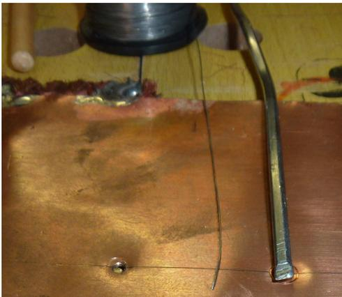
Por último mostrar la diferencia del grosor en el hilo de estaño empleado para soldar los condensadores y el utilizado en esta soldadura.
