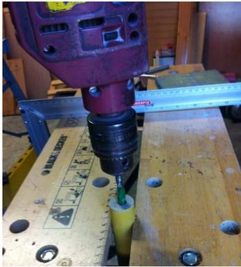
Para mantener en posición vertical la barra de madera en el interior del cilindro de cristal se realizo un taladro en la base de la barra de madera de 8mm de diámetro.
