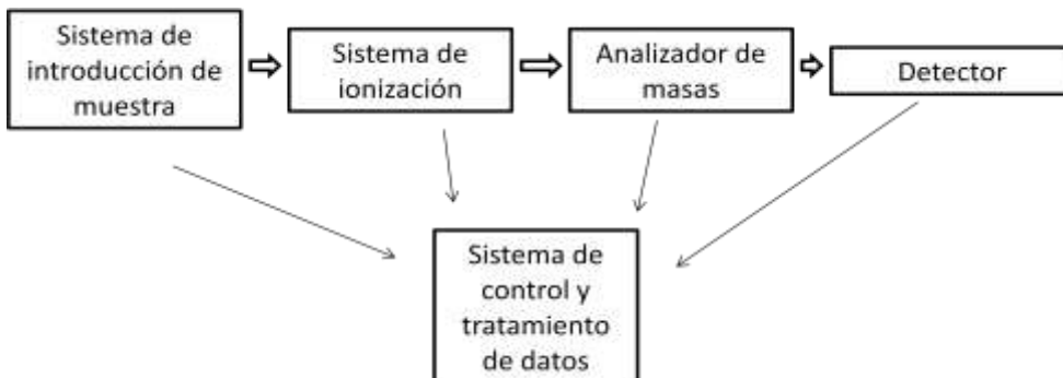
Figura 6. Componentes de un espectrómetro de masas.
