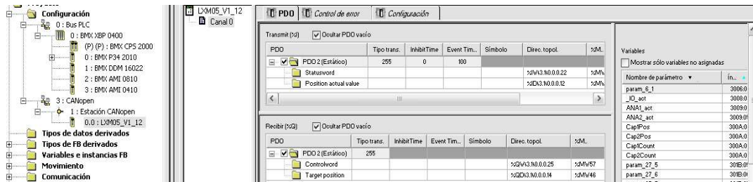
Vista de la configuración del bus CANopen en relación al dispositivo LEXIUM
