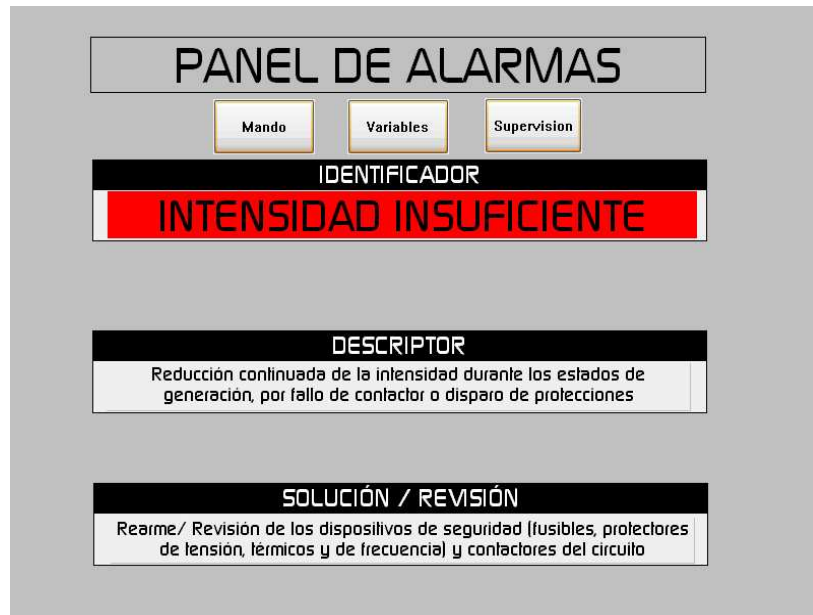
Vista de la pantalla de operador Alarmas indicando una alarma de Intensidad
