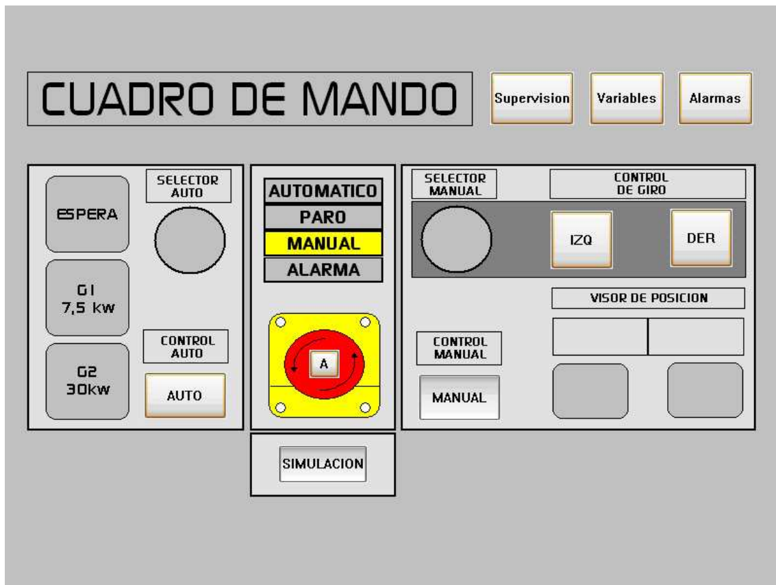
Vista de la pantalla de operador Mando en modo manual y posición 180°
