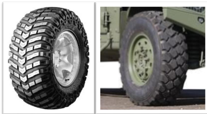
Ilustración 11. "Neumáticos de tamaño 37 X 12.5 / R17, empleados por el VAMTAC" Fuente: [3]
