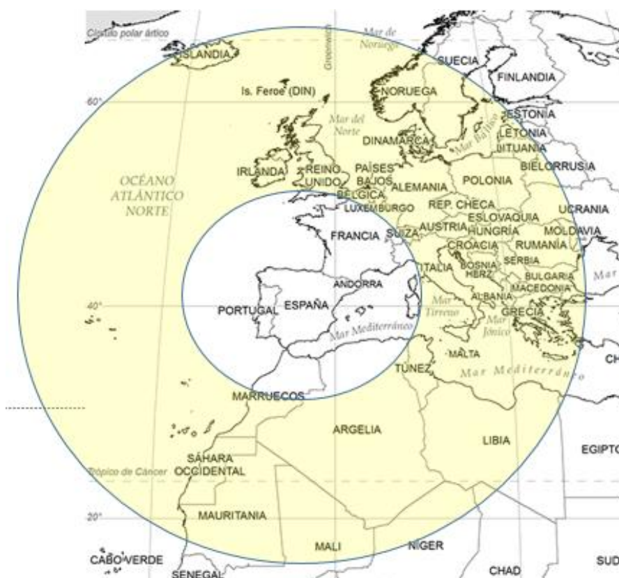
Figura 3- 8: Comparativa del alcance A400M C-130 (Base partida y regreso Torrejón, carga 20tm.) Fuente: Elaboración propia
