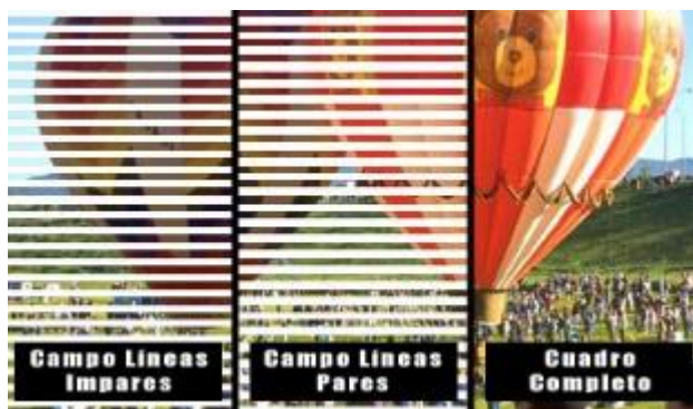
Figura A-6 Visualización de los cuadros de una imagen escanada de forma entrelazada (Fuente: [7])
