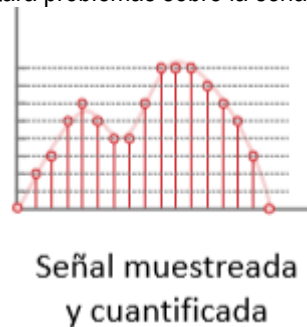
Figura A-5 Señal analógica tras su muestreo y cuantificación (Fuente: [8])
