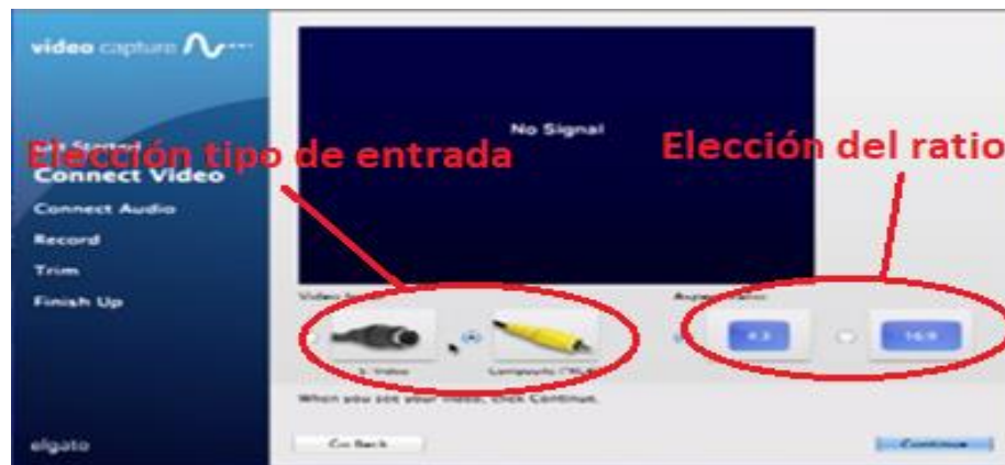
Figura D-2 Menú de elección del tipo de entrada de vídeo y del ratio del video de salida (Fuente: elaboración propia)
