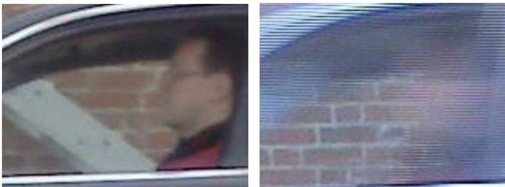
Figura A-8 Izquierda) Imagen ampliada de barrido progresivo Derecha) Imagen ampliada de barrido entrelazado (Fuente: [7])
