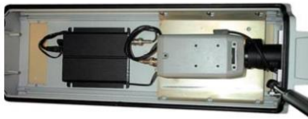
Figura 3-3 Codificador CCTV conectado a una videocámara (Fuente: www.axis.com )
