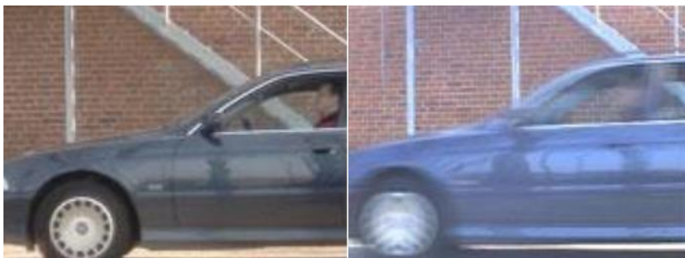
Figura A-7 Izquierda) Imagen capturada por barrido progresivo Derecha) Imagen capturada por barrido entrelazado (Fuente: [7])
