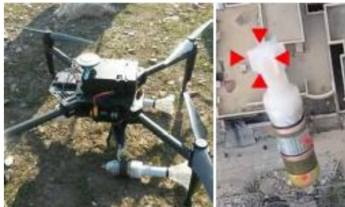
Figura 10. Cuadróptero con granada de mortero anclada [6].
