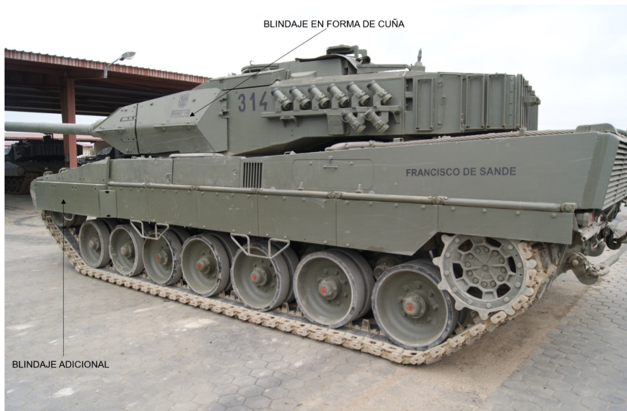
Figura 1. Carro de combate Leopard 2E, con sus sistemas de defensa pasiva / Fuente: https://commons.wikimedia.org/wiki/File:C-16-C.Combate_Leopardo_2E-9.JPG .
