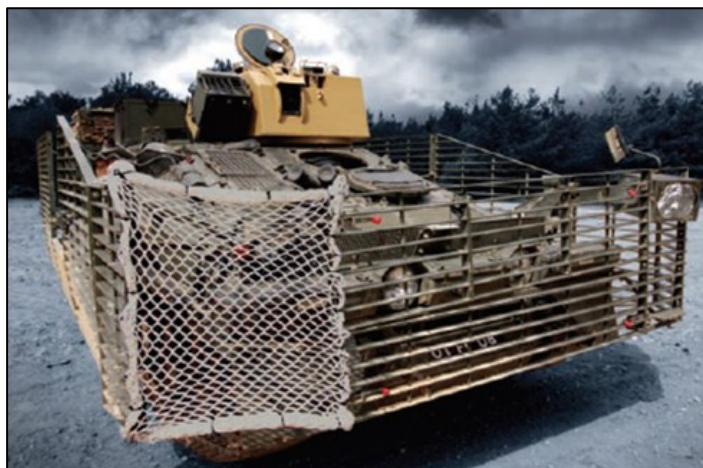
Figura 7. Vehículo protegido mediante un sistema SLAT ARMOR (en la esquina derecha del vehículo puede observarse una malla QuickShield de la empresa AmSafe) / Fuente: SHEPARD (2011), [38]).
