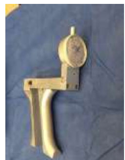
Ilustración 4: Dinamómetro empleado para realizar la valoración de la fuerza de prensión.
