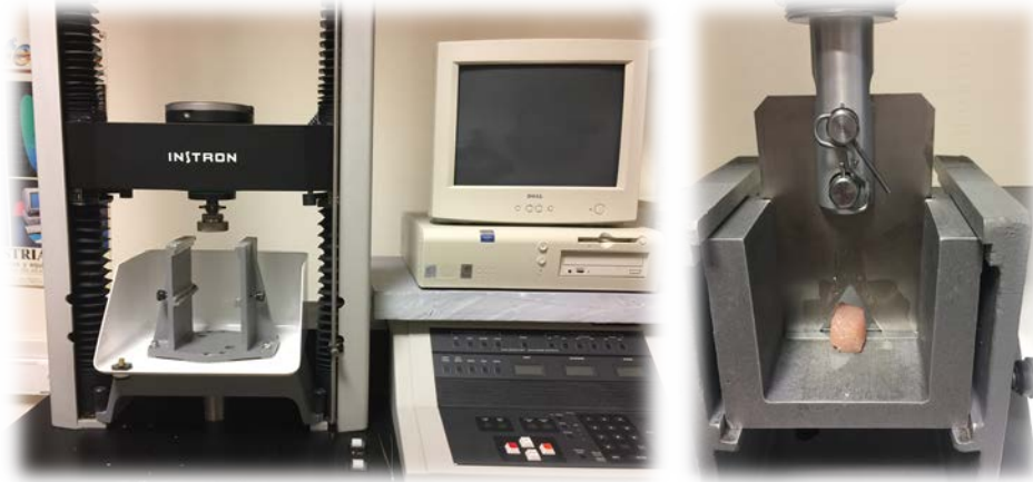
Figura 27. Máquina de ensayos universal INSTRON serie 4301 y célula Warner-Bratzler
