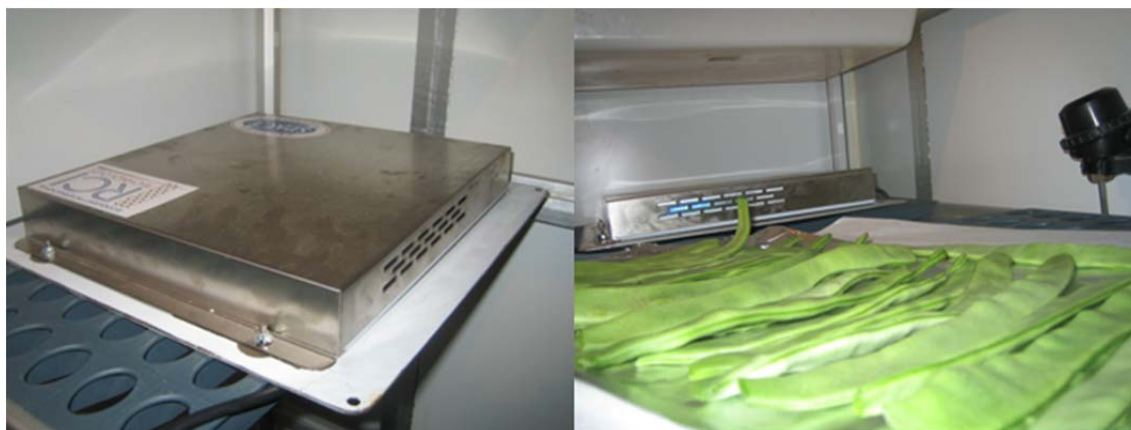
Fotografía 7. Equipo de Ionización catalítica radiante modelo Induct 500 dispuesto en la cámara de refrigeración, apagado (izquierda) y en funcionamiento (derecha)
