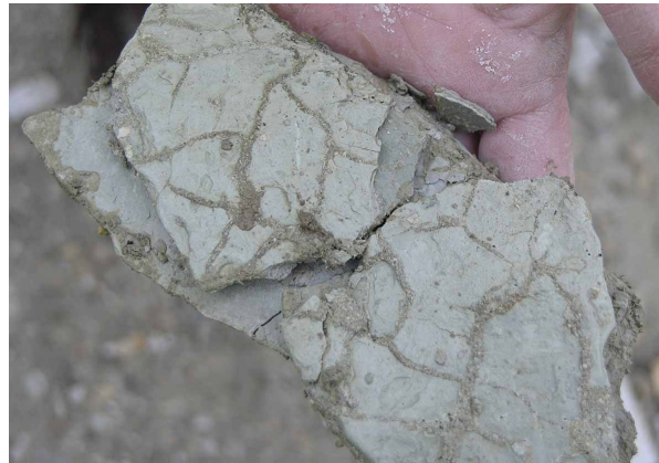
Figura 3.6. Detalle de aspecto en campo de margas con grietas de desecación rellenas por arenas.
