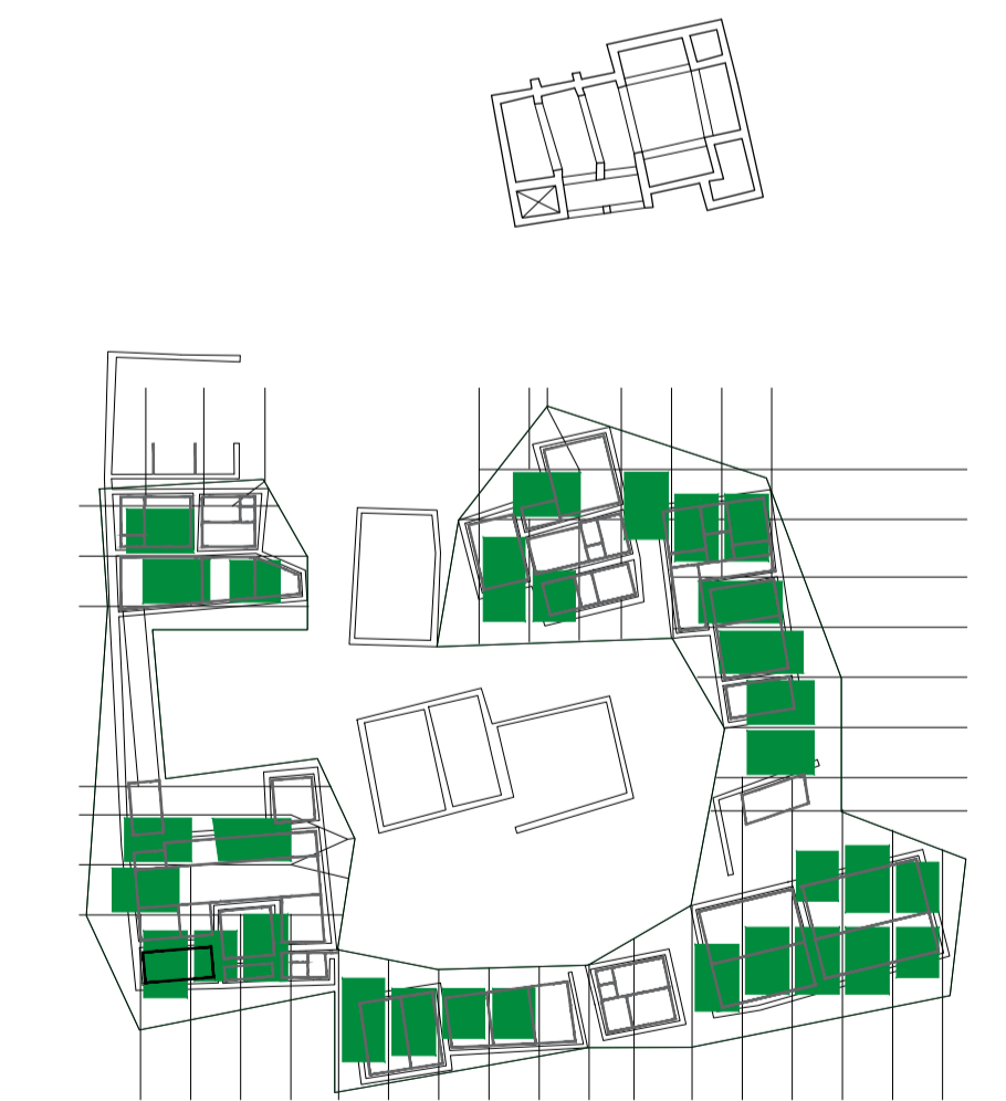
Esquema de estructura metálica. Pórticos metálicos N-S y E-O apoyados sobre "vasos de hormigón".
