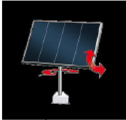
Figura 56 - Sistema de persecución con 2 ejes (Fuente [42])
