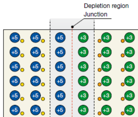
Figura 20 - Semiconductor con la zona de deflexión (Fuente [22])
