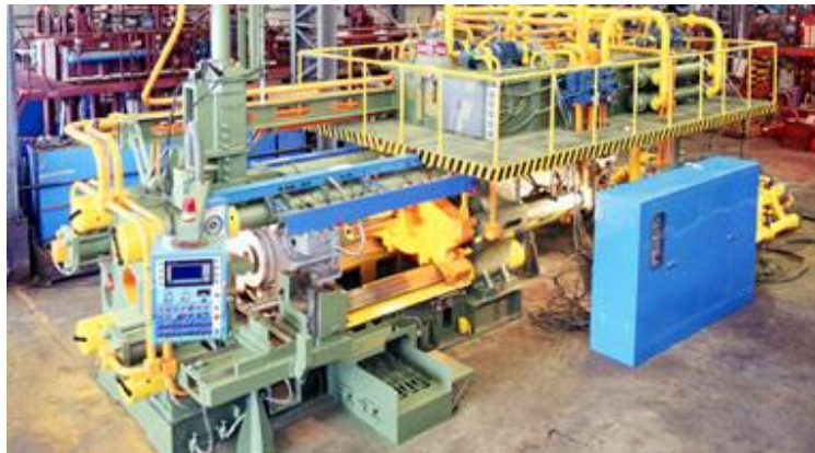
Ilustración 6. Prensa de extrusión hidráulica horizontal
