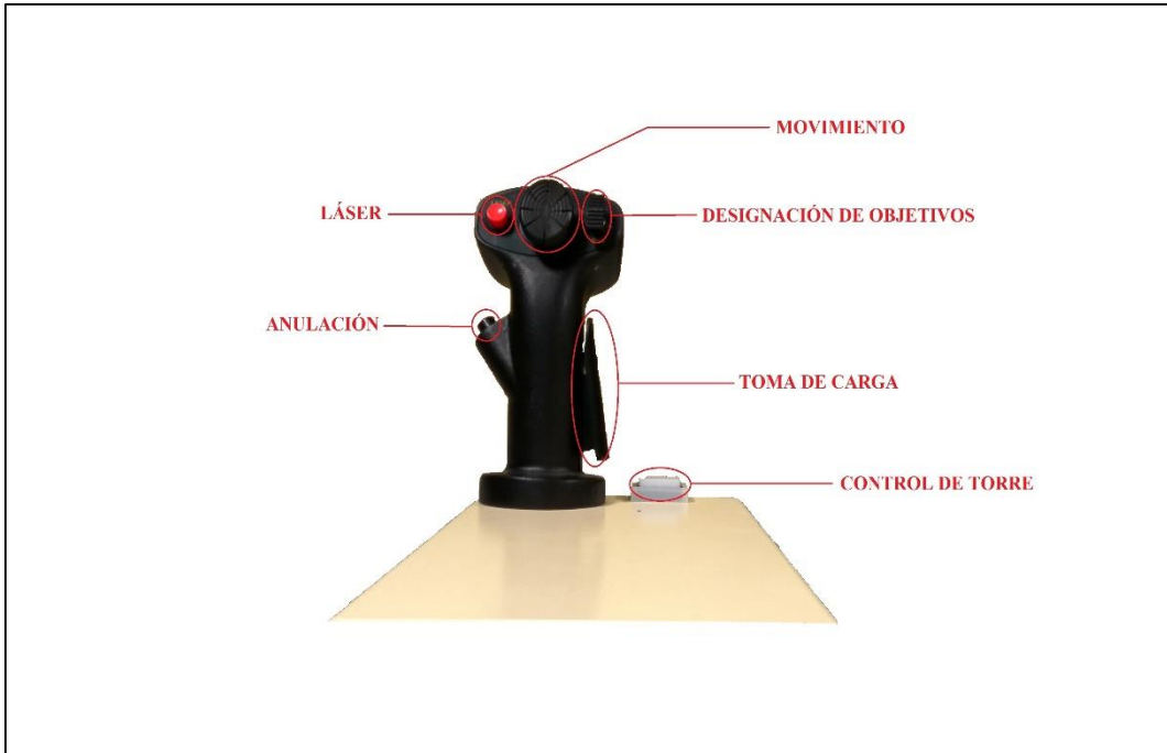
Figura C.3: Alzado del mando del jefe de vehículo del CC Leopard
