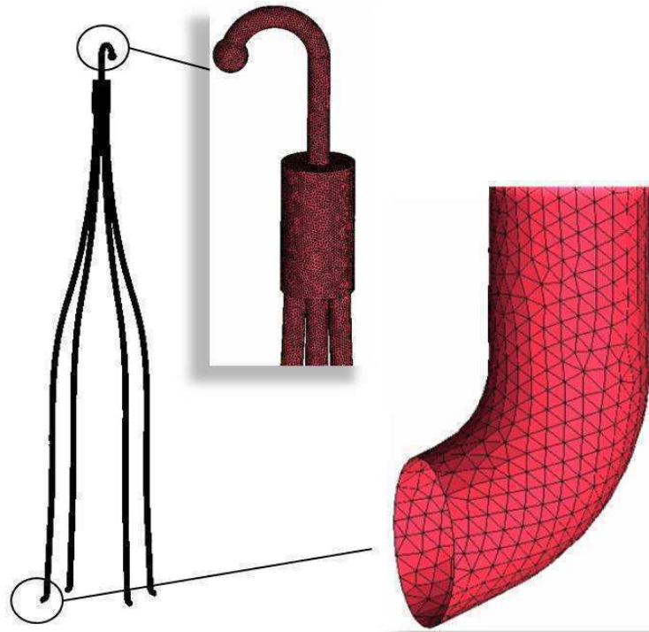
Figura 12. Malla generada en ICEM para el filtro antitrombo
