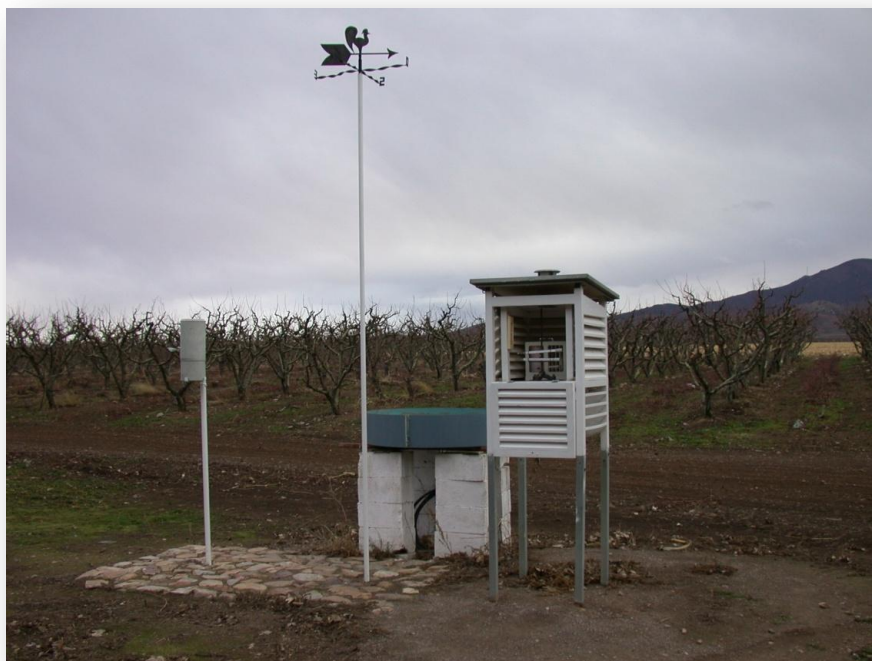
Figura 2: Estación meteorológica en La Almunia (Zaragoza). A la izquierda el pluviómetro que recoge las precipitaciones.
