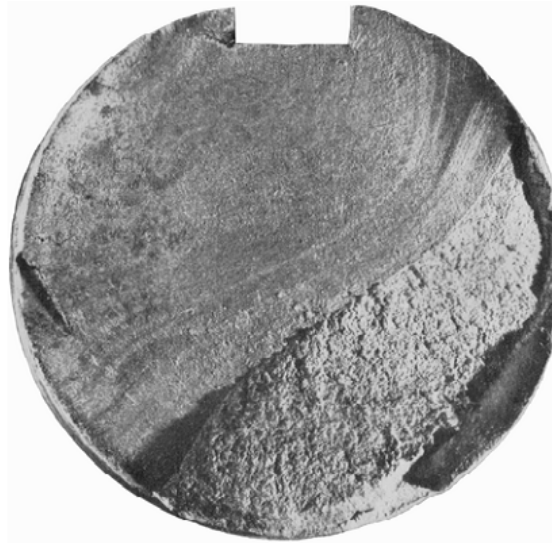
A. 1 - échecs par fatigue d'un axe
