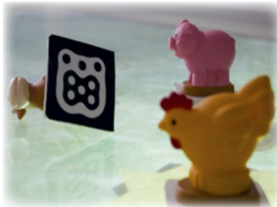
Imagen 2.9. Juguetes del tabletop NIKVision con fiduciales en su base.
