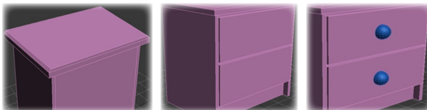
Imagen c.43. Modelado de un borde y dos cajones con sus pomos.
