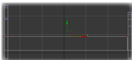
Imagen c.50. Vértices alineados con el comando Make planar en z .
