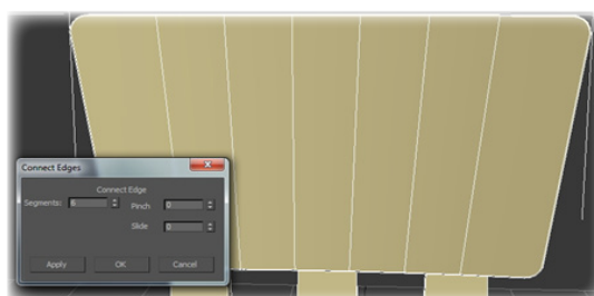
Imagen c.36. Seis aristas añadidas en el respaldo con la herramienta Connect .
