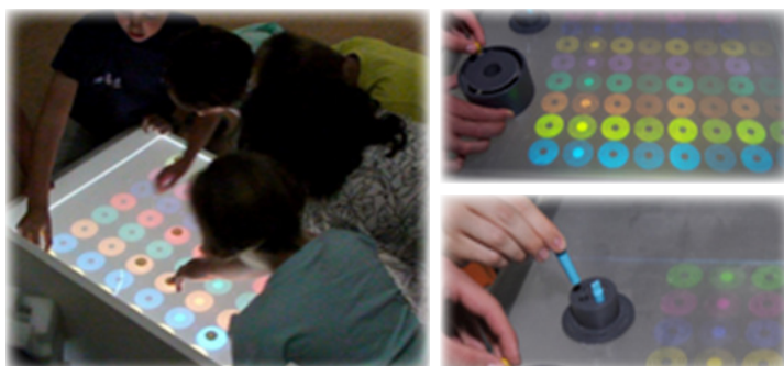
Imagen b.13. Secuenciador musical (izqda.); fader para controlar la velocidad de reproducción (dcha. superior) y almacenador de melodías (dcha. inferior).
