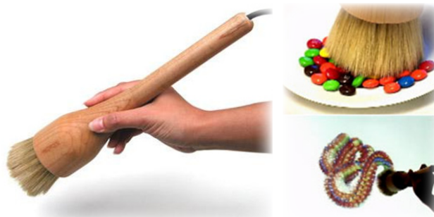
Imagen b.2. Pincel utilizado en el I/O Brush (izq.). Captura de una textura y aplicación sobre una pantalla (dcha.) [12]
