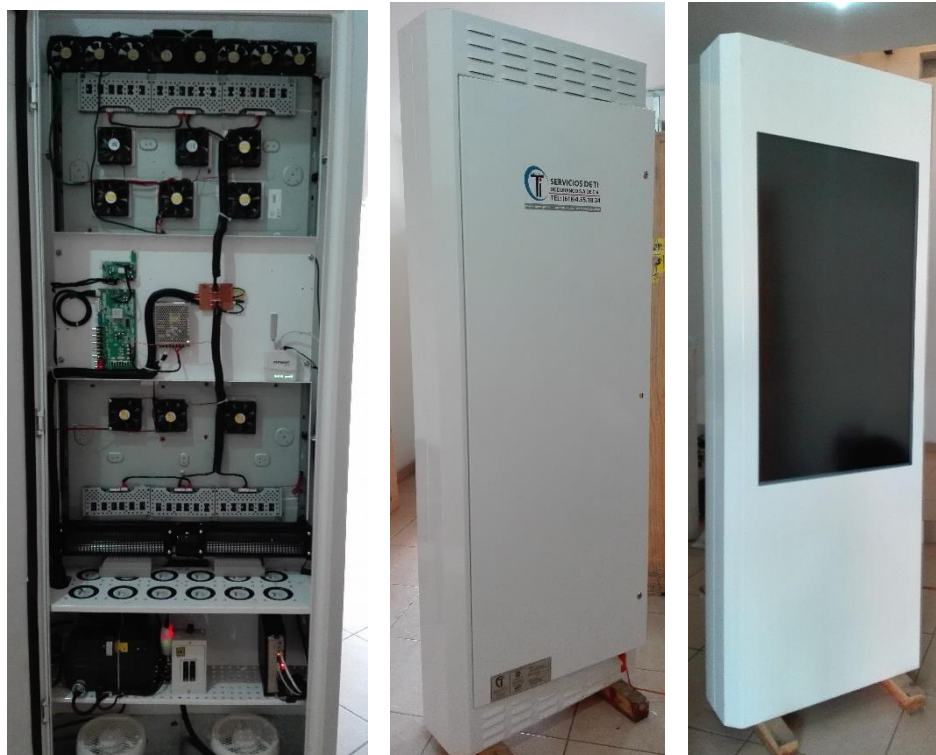
Fig. 3.1-7: Interior y exterior del tótem Luminia en su versión táctil.
