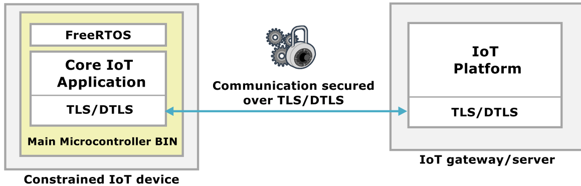
Fig. 2.3-15: Estructura ROM de un microcontrolador usando FreeRTOS y su comunicación segura sobre TLS o DTLS.
