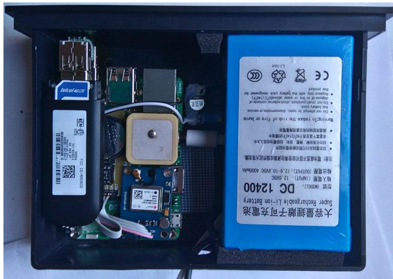
Fig. 3.1-12: Instalación del player en un contenedor estándar DIN-1. Este dispositivo ya incluye la batería de ión de litio de respaldo y el módem de banda ancha por Universal Serial Bus (USB).
