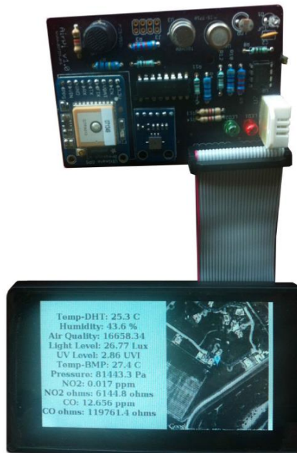
Fig. 3.1-8: Sistema secundario: Módulo AirPi V 1.0 funcionando conectado a una RaspberryPi.
